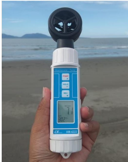
Gambar 3.3. Anemometer Lutron AM-4222 sebagai alat pengambilan sampel kecepatan angin di pesisir Gampong Alue Naga, Kota Banda Aceh
