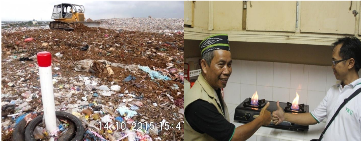
Gambar 3.56 Pipa Vertikal Pengumpul Metana dan Penggunaan Metana untuk Memasak
