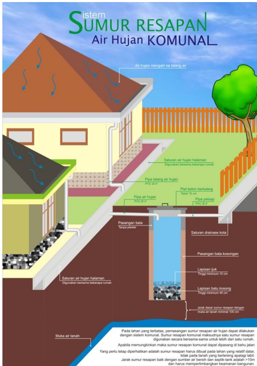
Gambar 3.76 Sumur Resapan Komunal
