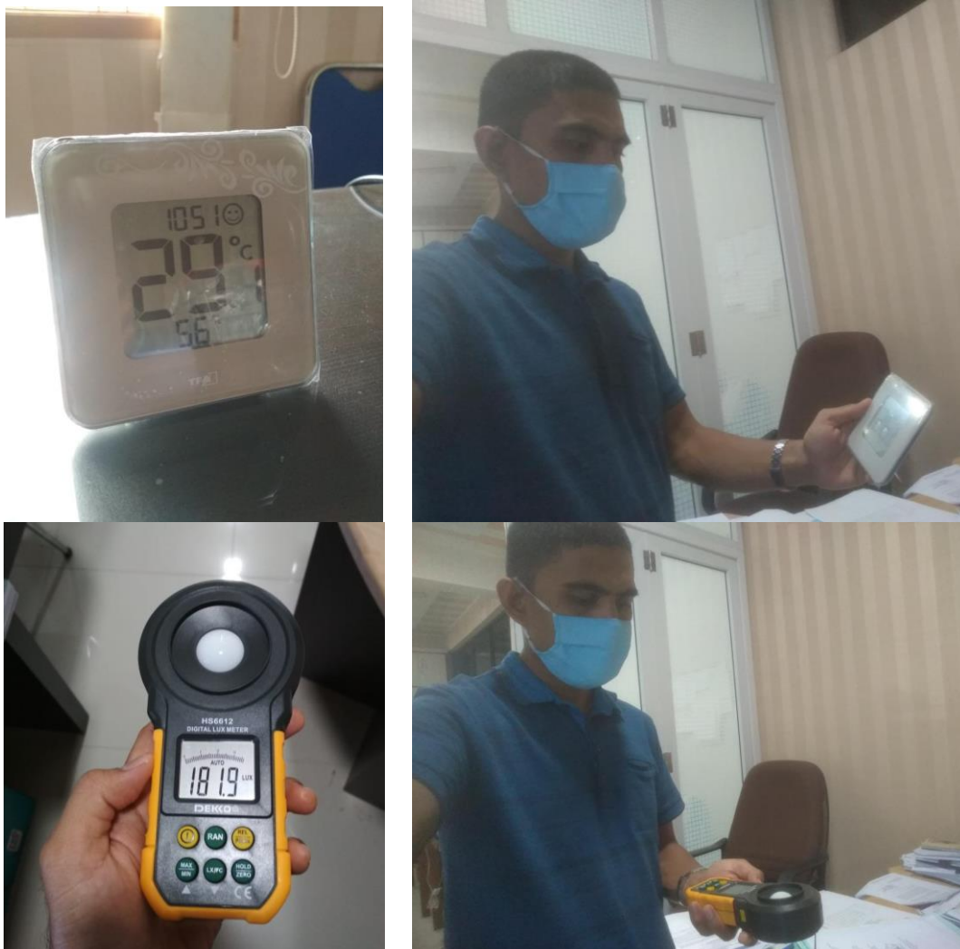
Gambar 2.15 Penggunaan Hygrometer dan Lux meter di Kantor Bappeda Kota Banda Aceh
